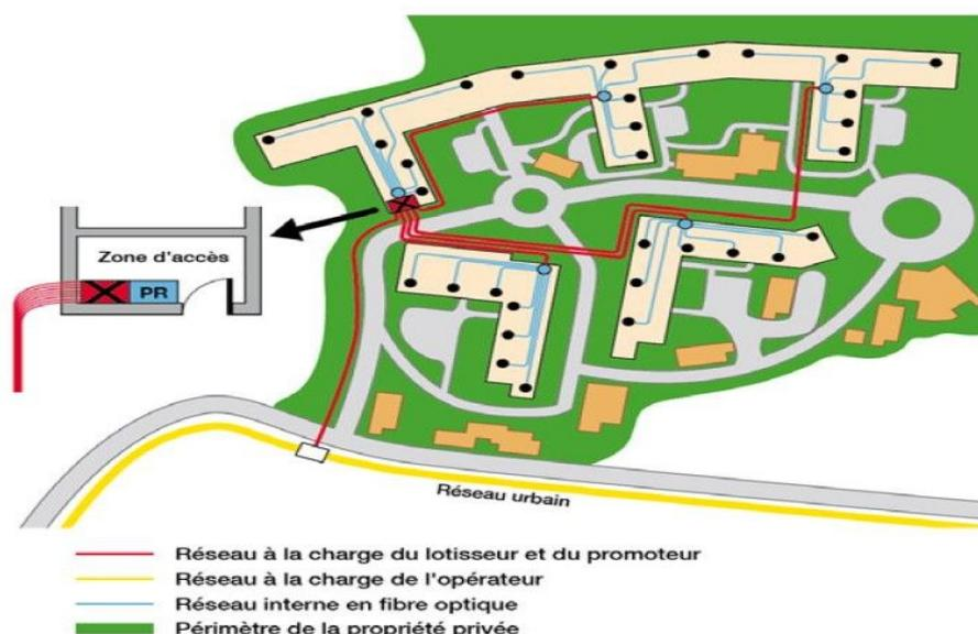
**Figure 2 :** Principe du service d'accès au câblage d'un ensemble d'immeubles ou lotissement.
