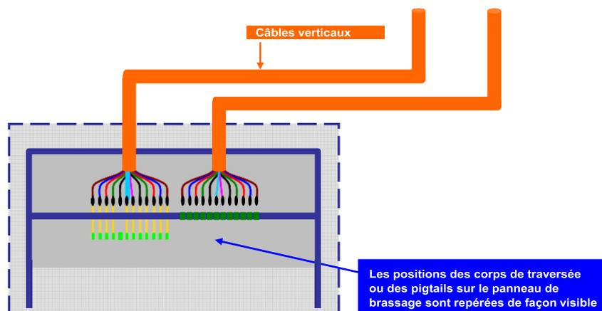
L'affectation des positions des corps de traversées ou des pigtails avec les couleurs de tubes et les couleurs de fibres des câbles verticaux est laissée à l'appréciation de l'opérateur d'immeuble en fonction de ses règles d'ingénierie.
