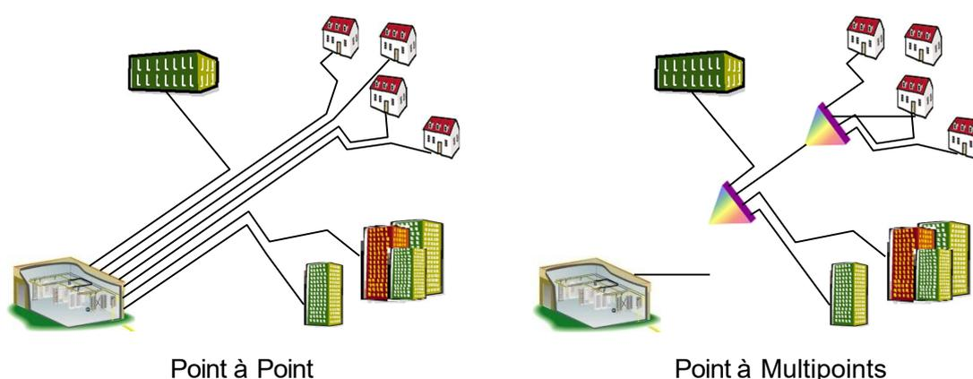
Figure 2 : Architectures de réseaux optiques FTTH
