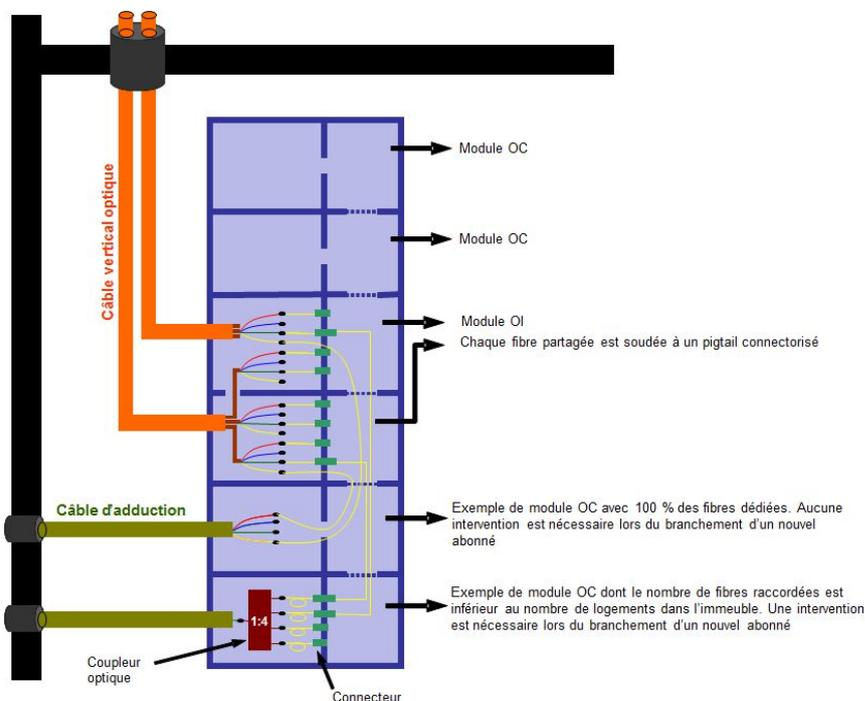
Schématiquement, le PRI réalise les fonctions suivantes :
